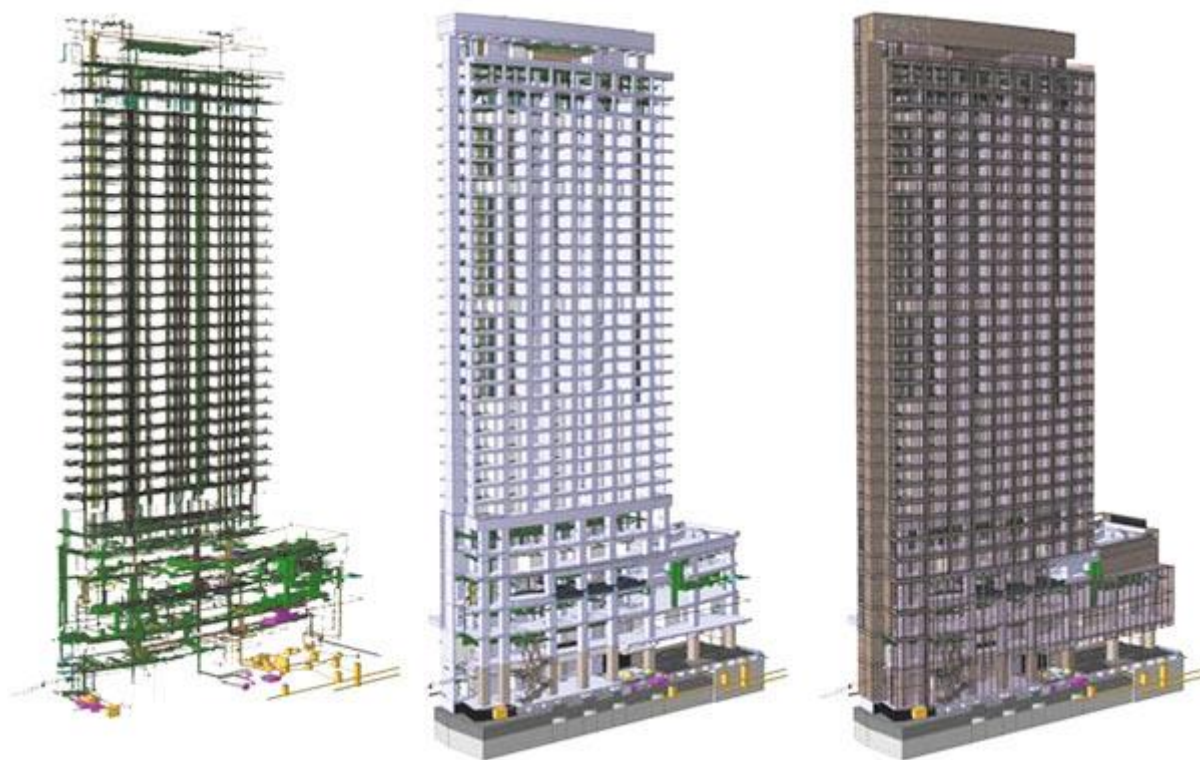
Рис. 2. Информационная модель отеля «Восток» в Гонконге. Показано последовательное совмещение схемы установки оборудования, несущего каркаса и части перегородок здания (при участии фирмы Gehry Technologies, 2004)
